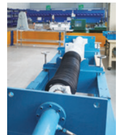
重型阻尼器测试机 (自研)
